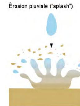
Figure 174 : Schéma de l'effet "splash" (Guide AFB relatif à la protection des milieux aquatiques en phase chantier)
