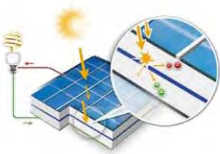
Figure 165: Principe de fonctionnement de l'effet photovoltaïque (Source : HESPUL)
